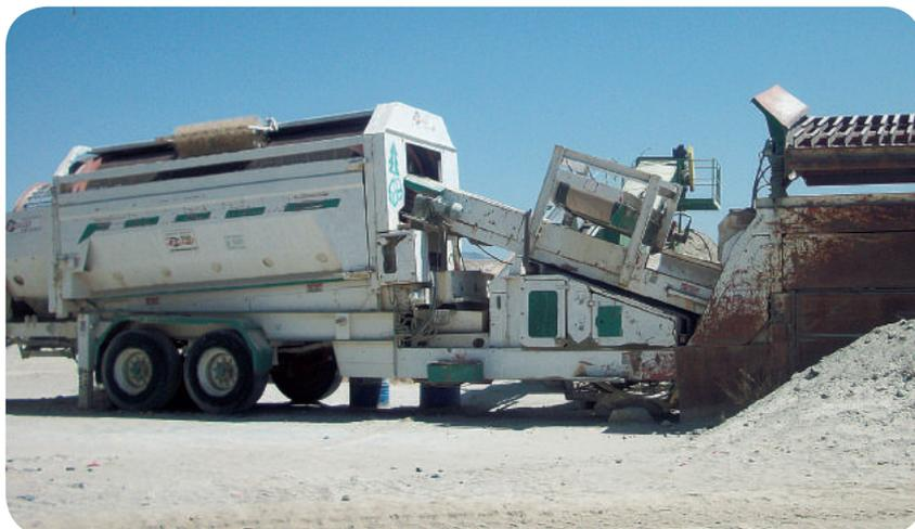
El material pasante, se considera como material de rechazo y se destina bien a vertedero, o bien para obras internas de mantenimiento y explotación de dicho vertedero. La luz de esta criba depende del criterio del propio gestor, aumentando ésta conforme más seguro se quiere estar de haber eliminado las tierras y partículas finas, a pesar de correr el riesgo de eliminar parte de material exento de éstas. En todo caso, suele estar comprendido entre 10 y 40 mm.
