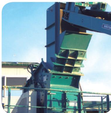
El molino de impacto es imprescindible para obtener un árido con una granulometría continua y con un número de caras de fractura adecuado. Después del molino de impacto es necesario disponer un segundo electroimán para eliminar el acero liberado en el fraccionamiento del RCD.
